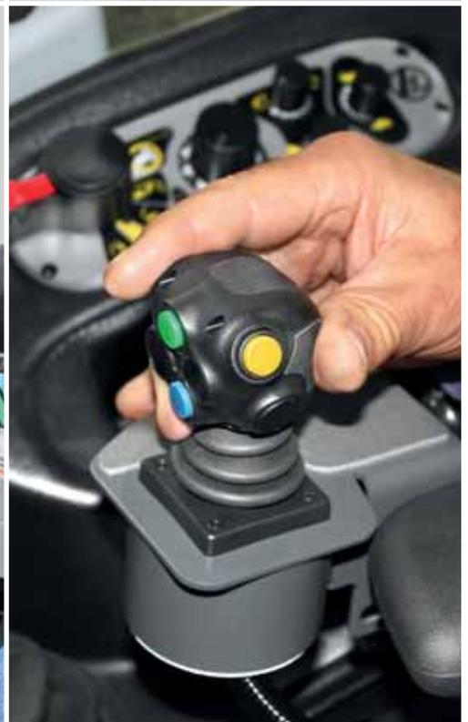
Der ergonomische Bedienhebel des Bowdenzug-Einhebel-Steuergeräts wird griffünstig für den Fahrer in der Schlepperkabine montiert.
