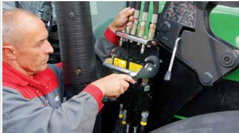
Die Hydraulikleitungen werden mit dem HYDRO-FIX mit einem Handgriff angeschlossen.
