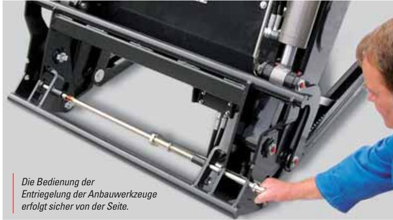
Die Bedienung der Entriegelung der Anbauwerkzeuge erfolgt sicher von der Seite.
