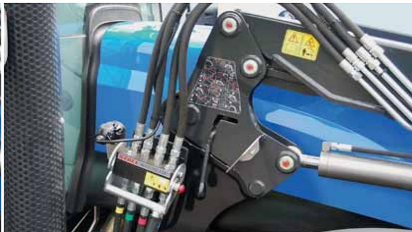
Schnell ist der Lader angebaut und verriegelt. Das dauert nur etwas mehr als eine Minute – und aus dem Traktor wird eine landwirtschaftliche „Lademaschine“.
