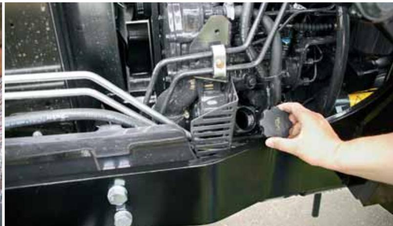
Die täglichen Wartungspunkte des Traktors sind immer frei zugänglich – auch bei angebaitem Frontlader.
