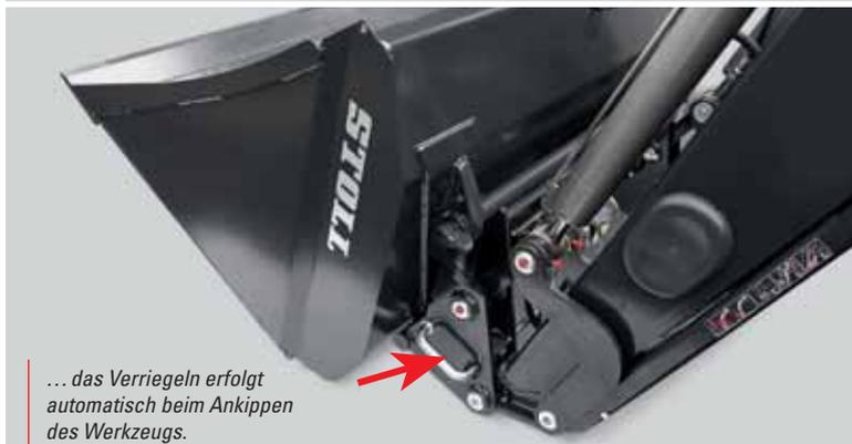
... das Verriegeln erfolgt automatisch beim Ankippen des Werkzeugs.
