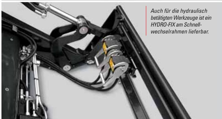
Auch für die hydraulisch betätigten Werkzeuge ist ein HYDRO-FIX am Schnellwechselrahmen lieferbar.
