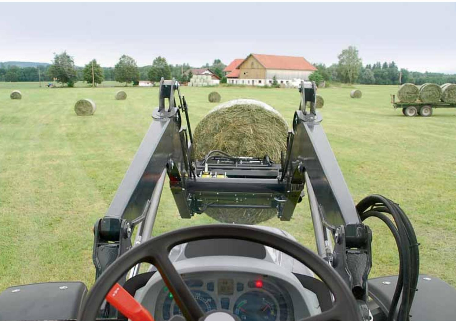
Keine störende Steuerstange und keine Hydraulikleitungen stören das Sichtfeld des Fahrers.
